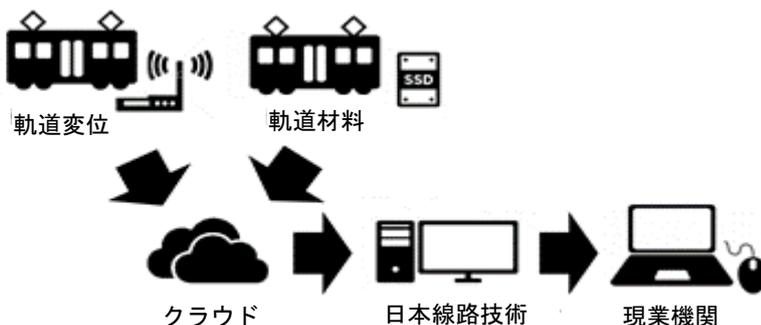
線路設備モニタリングのデータの流れ
