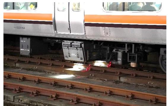
線路設備モニタリング装置による測定
