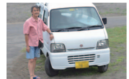
全長 3395mm 全幅 1475mm 全高 1815mm 車両重量 970Kg 最小回転半径 4.5m
