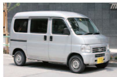
全長 3395mm 全幅 1475mm 全高 1880mm 車両重量 960Kg 最小回転半径 4.5m
