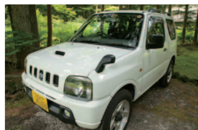
全長 3395mm 全幅 1475mm 全高 1680mm 車両重量 980Kg 最小回転半径 4.8m
