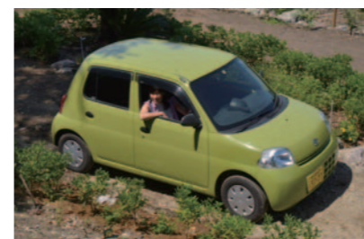
全長 3395mm 全幅 1475mm 全高 1470mm 車両重量 780Kg 最小回転半径 4.4m ※生産販売終了
