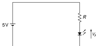
図1-19 LEDの基本駆動回路
