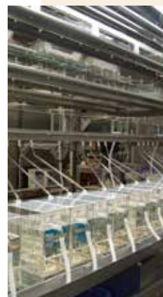
流水式装置による試験
