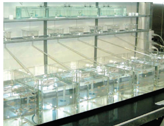
ヒメダカを用いた毒性試験の飼育水槽
