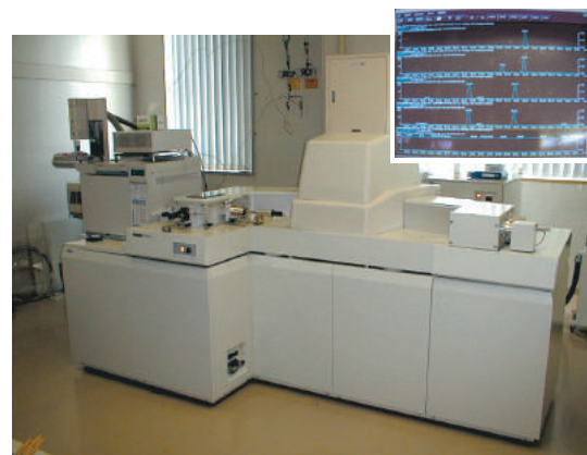
極微量物質の定性・定量分析（高分解能GC/MS）
