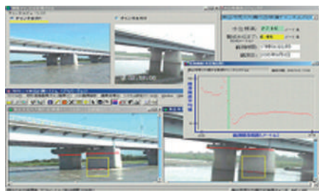
CCTVカメラを用いた水位計測(特許第3907200号)
