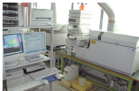
極微量不純物分析のための誘導プラズマ質量分析計
