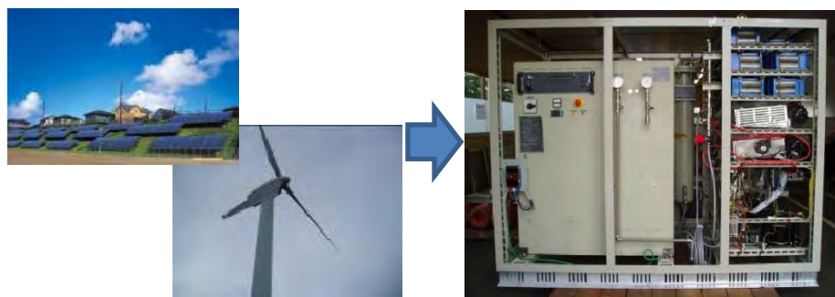
図3. 自然エネルギーと水電解システムを組み合わせた蓄電システム(企業との共同研究成果)
