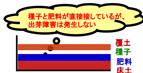
育苗箱 専用肥料を施用した水稻育苗箱の断面
