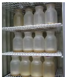
室内腐朽試験
