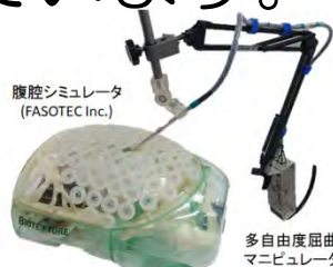
図2 腹腔鏡手術支援用屈曲マニピュレータ
