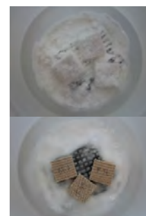
腐朽試験中の 木材試料
