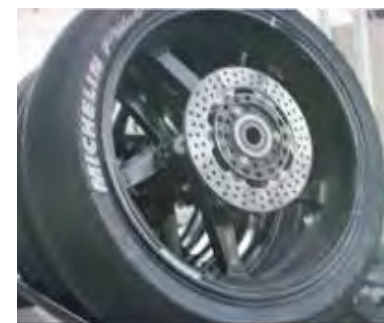
図4. アルミ合金上に鉄クロム合金めっきされたオートバイ用ブレーキディスク(企業との共同研究成果)
