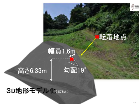
図2 事故現場の地形を測量とCADにより3Dモデル化し、事故原因を特定。
