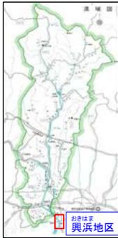
流下能力を向上させるため、本町橋の改築を継続して実施するとともに、河口付近の河道掘削を行う。河道掘削にあたっては、塩沼植物群落の生育環境に配慮するとともに、感潮帯が復元できるような掘削形状の検討を行う。
