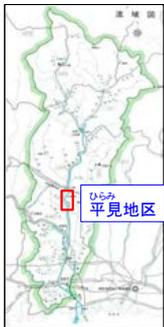
堤防が整備されていない地区の堤防整備を行うとともに、流下能力を向上させるために河道掘削を行う。河道掘削では、水際植生を極力保全するとともに、樹林化した丸石河原が再生できる掘削形状の検討を行う。
