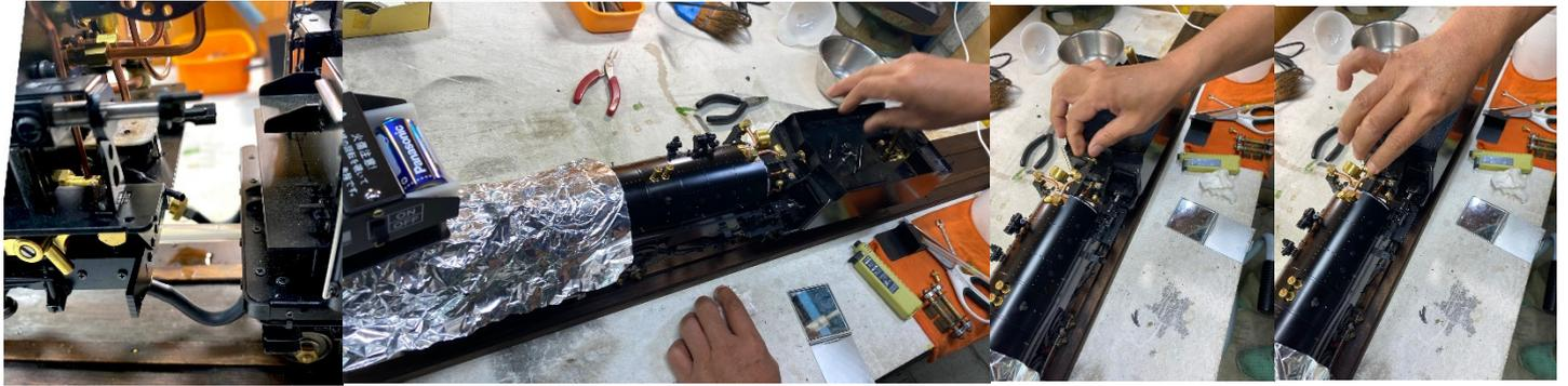
5: 新品電池に交換したブロアー(サクシオンファン/通風機)を煙突に乗せスイッチオン。D51 の場合、火傷防止手袋装着。
