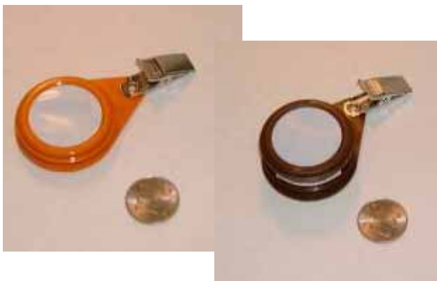
写真1 有機ガスモニター、3M #3500(左)及び #3520(右)
