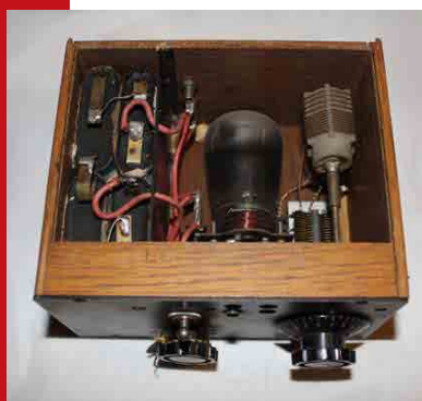
Radio-récepteur bricolé avec lampe à batterie, utilisé par la résistance, v. 1942.
