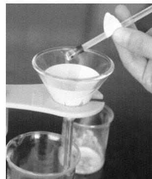
写真5. あらかじめちぎり取っておいたろ紙片で、ポリスマンに付いた沈澱をふき取り、合わせて処理する
