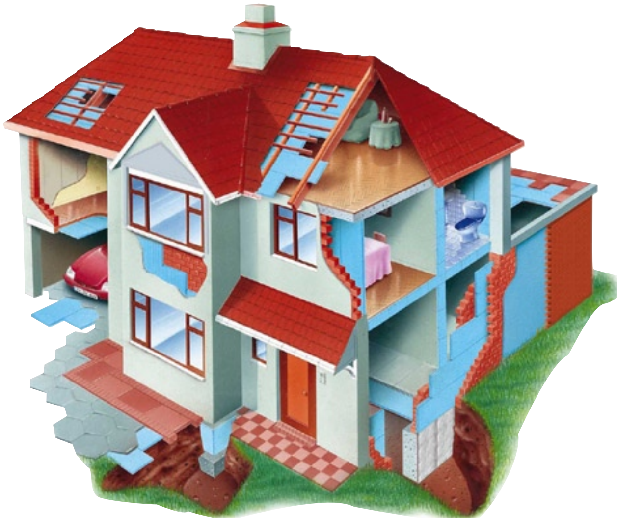
Рисунок 4.1 Схема расположения теплоизоляции STYROFOAM в жилых зданиях
