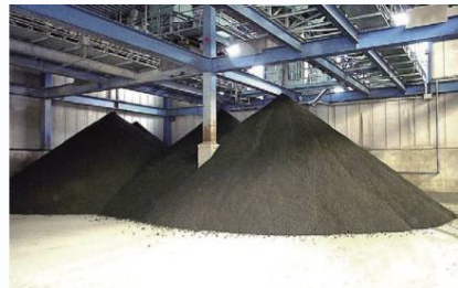
浄水場発生土
