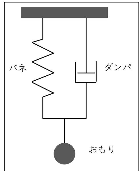
図 63 バネ・ダンパモデル
