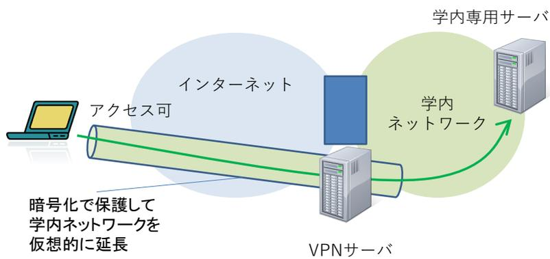
**注意：** 組織内のネットワークに VPN 接続すると、VPN 接続元のパーソナルコンピュータからのインターネットへのアクセスも VPN 経路で行われ、その組織の制限が適用されるます。その組織で禁止されている通信は行ってはいけません。
