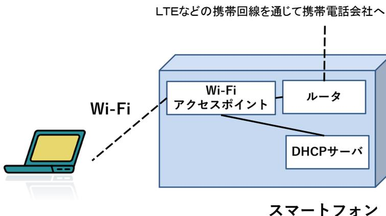
図 25 スマートフォンを用いた Wi-Fi テザリング
