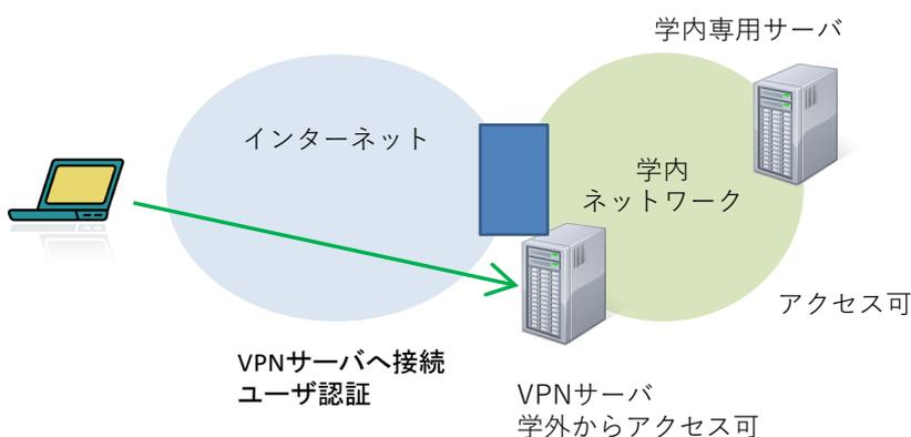
2. VPN サーバは接続してきたパーソナルコンピュータとの間に暗号化により保護した通信経路をインターネット上の仮想の経路を作り、パーソナルコンピュータから学内のネットワークへの通信を許可します。
