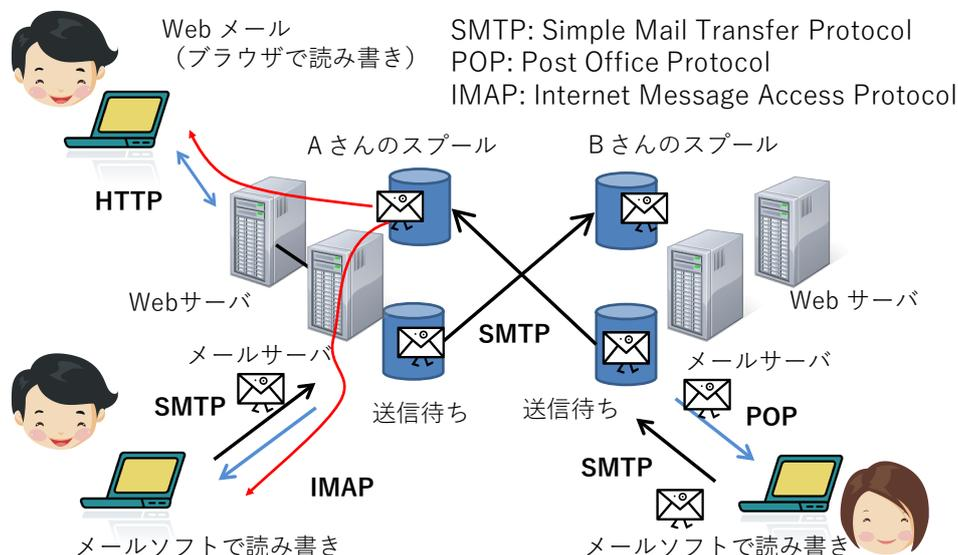
図 36 電子メールの仕組み
