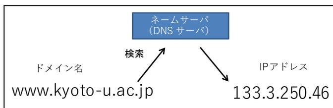
図 33 DNS によるドメイン名から IP アドレスへの変換
