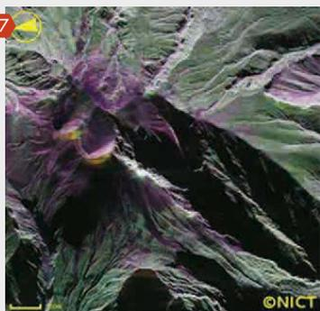
07 我が国では、東日本大震災や御嶽山噴火のように、被害の状況把握が難しく、また広範囲にわたる大規模な自然災害が多発している。航空機に搭載した9GHz帯合成開口レーダーシステムは、夜間や噴煙など視界がきかない状況においても、上空から電波を用いて被災・災害状況の広範囲での情報収集を可能とする。総務省は、平成30年に同システムの技術基準を策定したところであり、今後の活用が期待されている。写真は同システムで撮影した平成26年10月2日13時頃の御嶽山山頂付近の様子。（提供：NICT）
