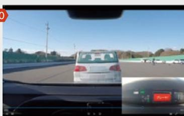
09 10 犯罪の捜査に関連する物理学や応用物理学の研究とこれらの技術を応用する鑑定・検査や、情報科学を基盤として、筆跡識別、話者認識等の研究と鑑定・検査を行っている。また、交通事故に係る犯罪の捜査についての研究と鑑定を行っている。写真は、自動運転レベル1を搭載した車両の事故再現実験と、その車内計測データである。交通科学第三研究室では、自動車の運動特性と安全性に関する研究、交通事故分析に関する研究及び交通事故の鑑定を行っている。
