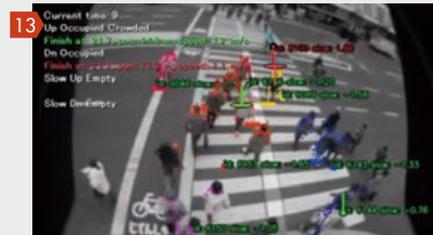
12 13 犯罪の捜査に関連する工学分野の研究とこれらの技術を応用する鑑定・検査及び交通事故防止に関する工学的研究を行っている。写真は、画像センサを活用した歩行者用信号時間の可変制御に関する実証実験の状況である。歩行速度の遅い横断歩行者の存在を画像処理で検知することで歩行者用青信号を延長し、赤信号時に残存する歩行者を削減するITS（高度道路交通システム）技術である。
