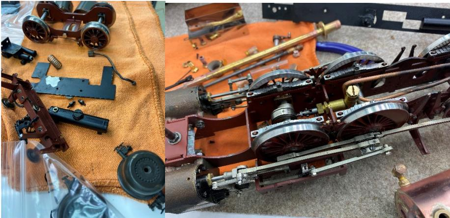
左写真の様に、全ての部品を外し脱脂して、小傷を確認し、在る場合は交換部品を用意してから組み立てています。又、機能部品は、水垢を取る為、再ポリッシュしてありますが、調子良く運転していた事が分かる、黒く変色したスパーヒータ等は磨いても、敢えて新品交換はせず、そのまま組み立てています。又バーナーは、欧州標準の小判型になります。
