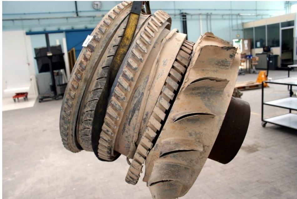
Fig.41: Compresor de baja presión del motor Nro.1.
