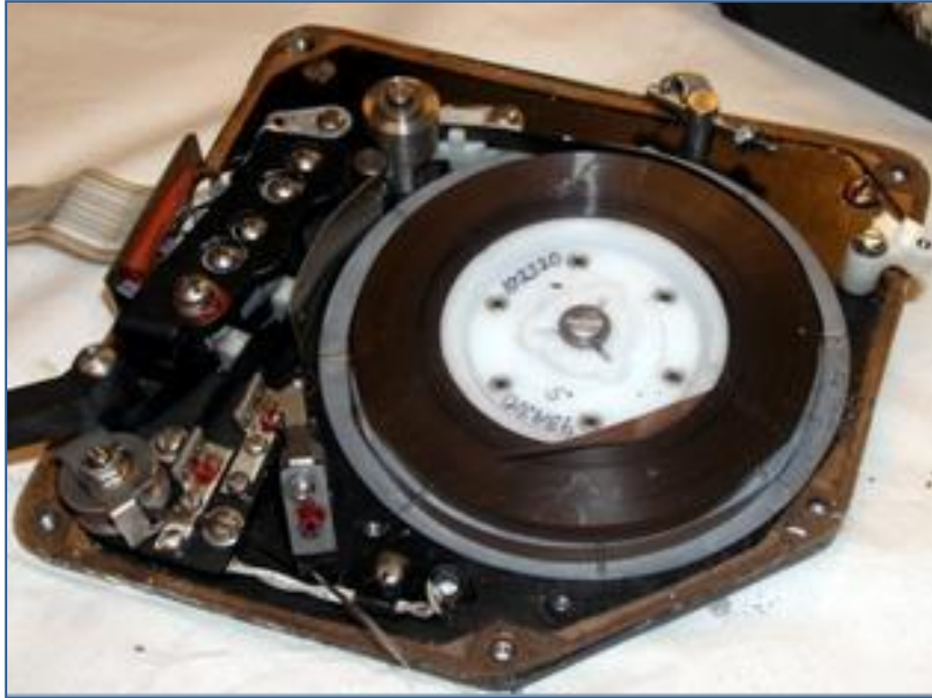
Fig. 36: Cinta magnética y mecanismo de CVR.
