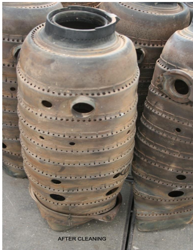
Fig.42: Cámaras de combustión del motor Nro.1.
