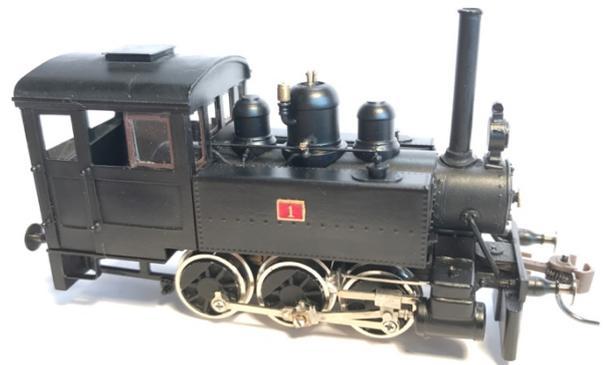
こういう実物とは違った機構は邪道だと思われ方もおられると思いますが、欧米の量産品をみていると、ロッド連動とギア連動を併用した製品もよくみかけますし、そういうモデルでは、ロッドピンがない動輪もあるようです。動輪径が小さく動輪のクランク半径が小さいと工作精度をあげないとうまく回らないので、ロッド連動にこだわらず、ギア連動にした方が楽だと思いました。ブレーキシューは寸法的に厳しく、走行時ショートの原因になりそうなので省略しました。余談になりますが、米国の N&G ガゼット誌主筆のボブ・ブラウン氏は走行トラブルの原因を減らすためブレーキシューはつけない主義だったと聞きましたが、走らすモデルには割り切りも必要だろうと思いました。
