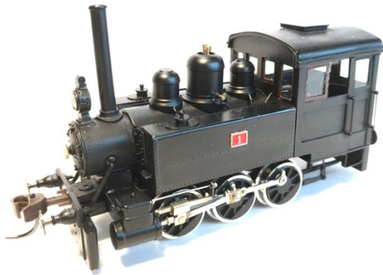
プロトタイプは、ゲージはサブロク (1067mm) といっても、ナローゲージのような小さな機関車です。他の車両と大きさの兼ね合いや下回りのアルパワーの軸距・車輪径に合わせて縮尺は 1/75 とし「16 番」規格としました。1/80 の車両に比べれば約 6% 大きいはずですが、並べてみてもかなり小さいです。図面は「新編 H. K. ポーターの機関車」の図面を参考にして設計しましたが、内田利次さんからは組立図のコピーもいただけたのでそれも参考にしました。シリンダー中心間隔は少し余裕をもって 25mm とし、車体幅はスケールより 1mm 広く 26mm と設計しました。
