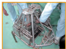
海底土を採取する装置
