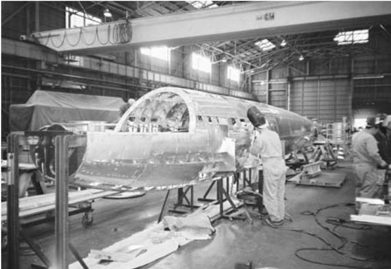
写真2.6.27 ステ張りを終え、プロペラ部スバントの取替えも完了
