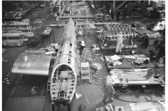
写真2.6.28 後部胴体外板張り完了の頃
