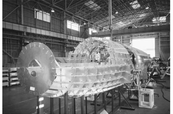
写真2.6.26 カウル部の切り欠き完了
