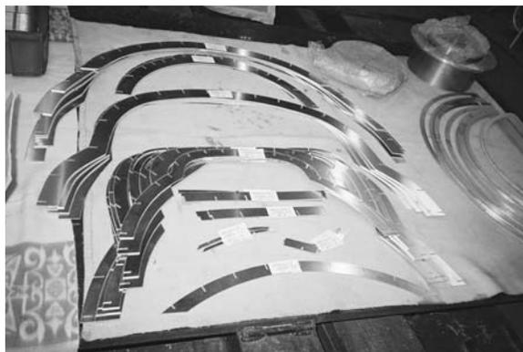
写真2.7.4 レーザ切断を終えた部品
