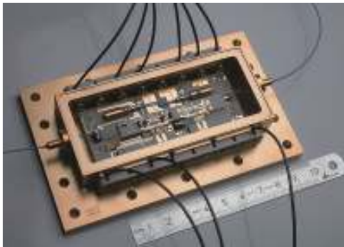
図3 JOKARUSミッションに向けたパワーアップ付マイクロ集積拡張キャビティダイオードレーザが示されている。(資料提供:FBH/schurian.com)
