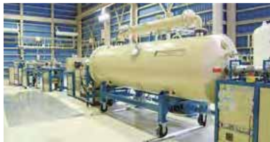
加速器の本体部分。200万ボルトの電圧でイオンを加速します。
