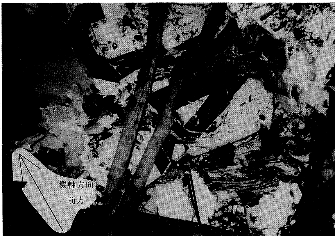
写真 2 - 3 事故機 (胴体下面の外板の皺)
