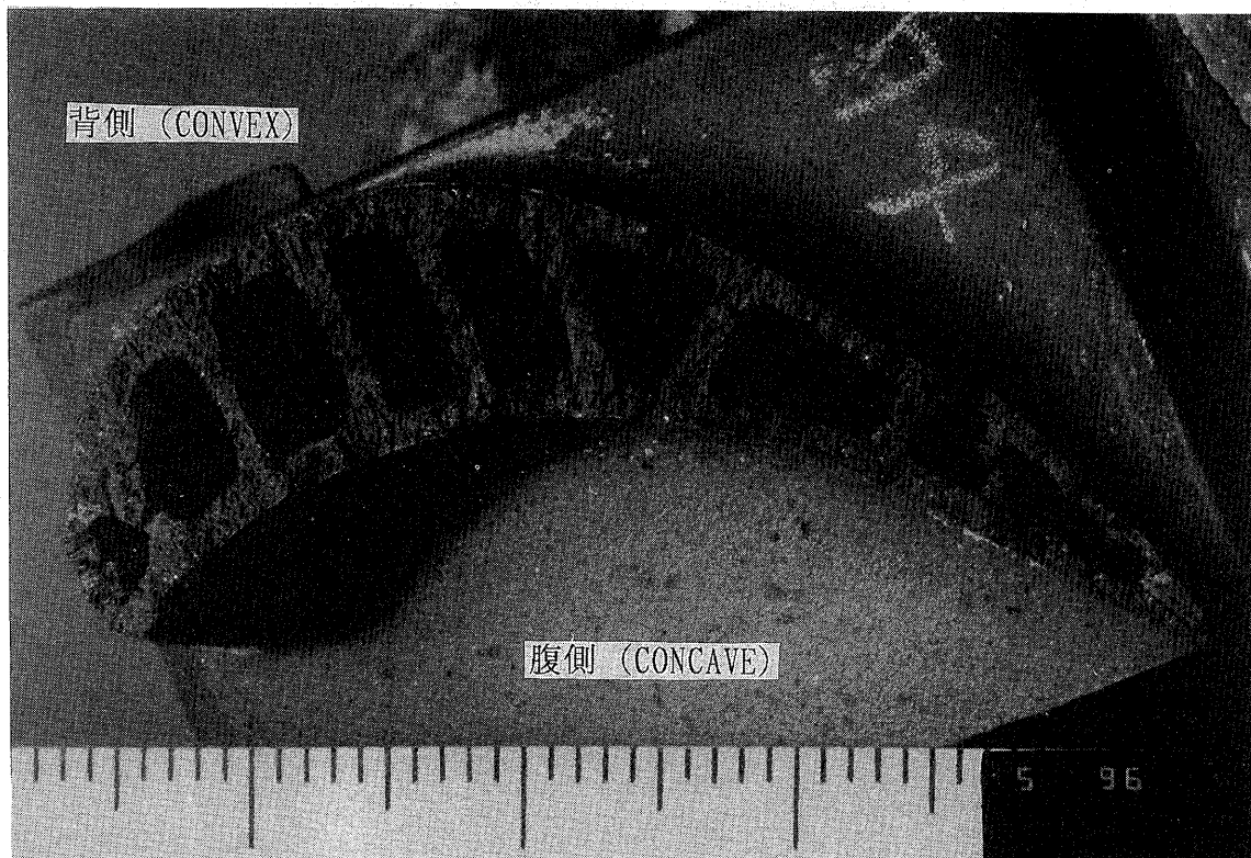
写真4-7 No. 3エンジン (第1段第74番ブレードの破断面)
