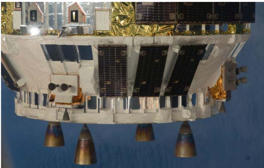
図A1.5-3 軌道上で撮影された推進モジュール（1号機） ©JAXA
