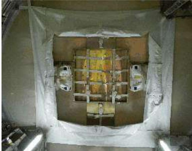
図 4.1-3 5号機から新設したHRRの搭載構造 ©JAXA
