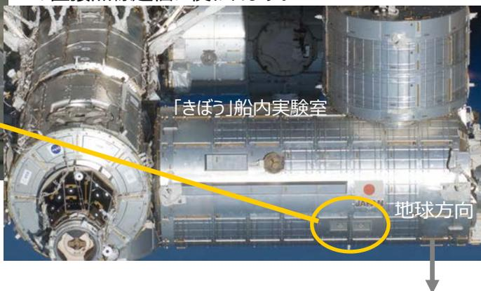
図A1.6-2 PROX通信アンテナ ©JAXA/NASA
