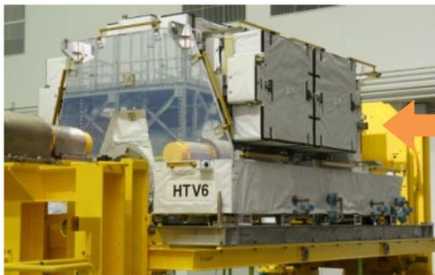
「こうのとりの」の曝露パレットへのバッテリー6台の設置
