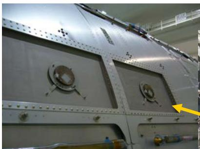
PROX通信アンテナは、ISS近傍に接近した「このとり」との直接無線通信に使われます。
