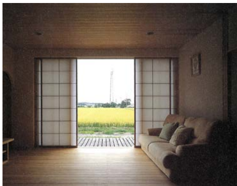
●（床板の反射） 塗装の種類、色によっては光を柔らかく反射して、部屋全体を明るくする（写真：①）
