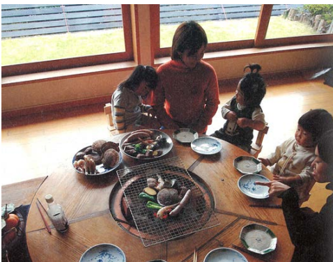
● (座卓の炉) 囲炉裏を床座の生活に組み込んだ例。炉に蓋をすれば普通の座卓としても使える (写真: ①)
