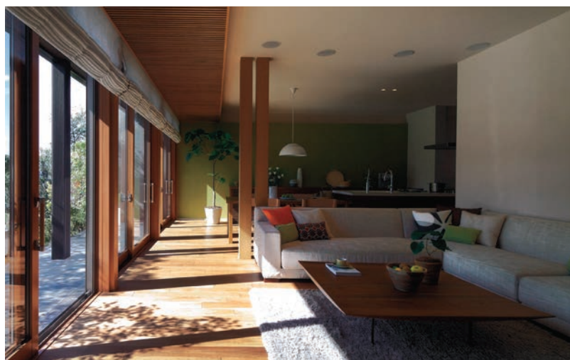
南面の連続する掃き出し窓と石張りの床。石やタイル等は蓄熱性が高い（写真：②）
