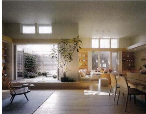
●（現代的な住まい）通常の天井高さで内法の上部分が開口となっている高窓の例（写真：④）
