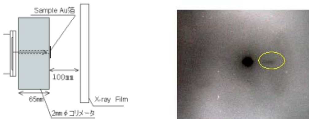
図5 (左) 回折光を計測するために 2mm のコリメータを置き、金薄膜からの回折光を 10cm 離れたX線フィルムで計測した。(右) が計測された回折光である。約 2 分の結果である。
