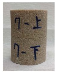
図3 岩石試験片(直径3cm)
