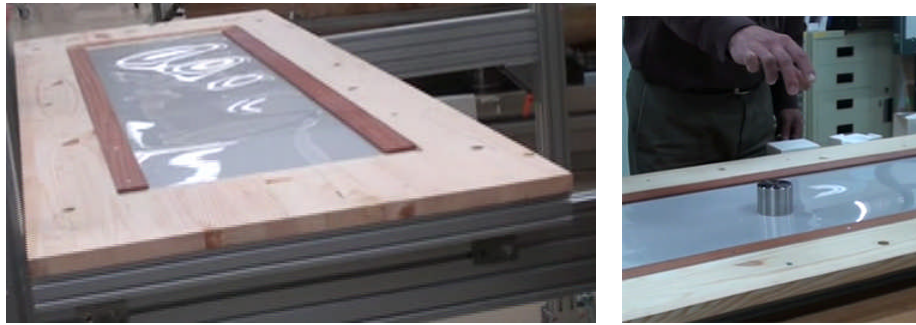
図3 「装置用の乗り板」(左) とセンサユニット相当錘の落下実験
