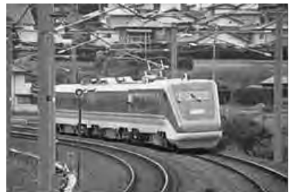
走行試験中のフリーゲージトレイン (JR 四国のホームページより)
