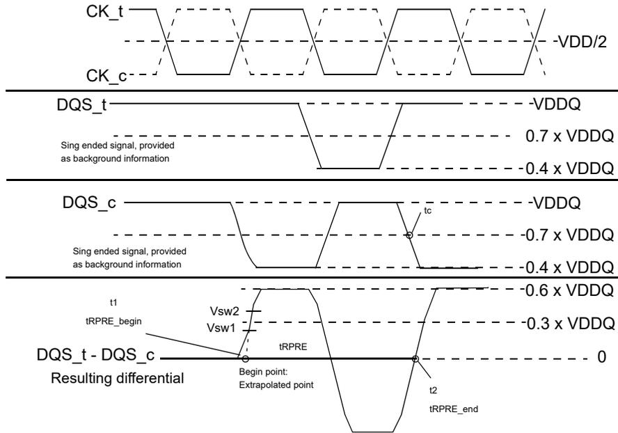
NOTE 1 Low Level of DQS<sub>t</sub> and DQS<sub>c</sub> =  $VDDQ / (50 + 34) \times 34$
