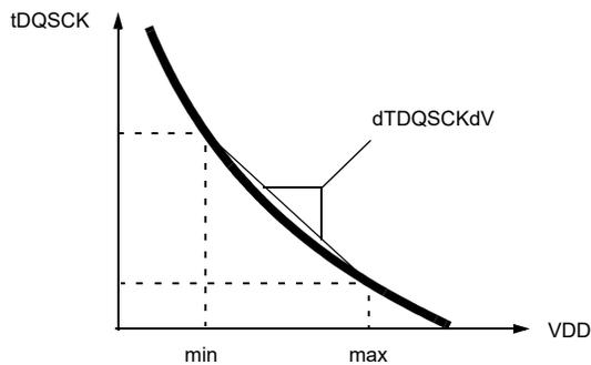
$$dTQSKdV = |tDQSK(VDD,max) - tDQSK(VDD,min)| / |VDD,max - VDD,min|$$
