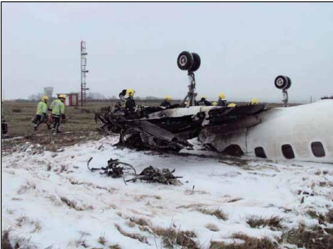
Fotografía N° 6: Daños en el ala derecha
