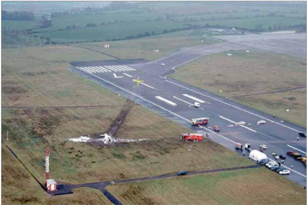
Fotografía N° 5: Punto de contacto inicial (identificado con la marca de referencia amarilla), rastro de residuos y posición final de los restos de la aeronave
