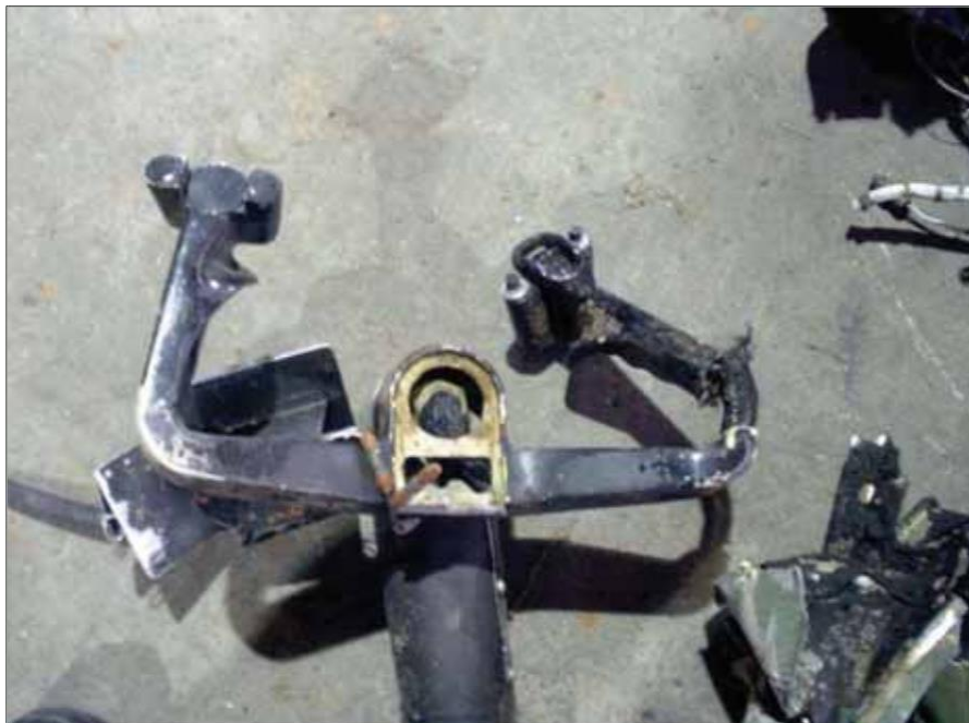
Fotografía Nº 7: Palanca de control del Copiloto que muestra la fractura de la empuñadura del control derecho.
