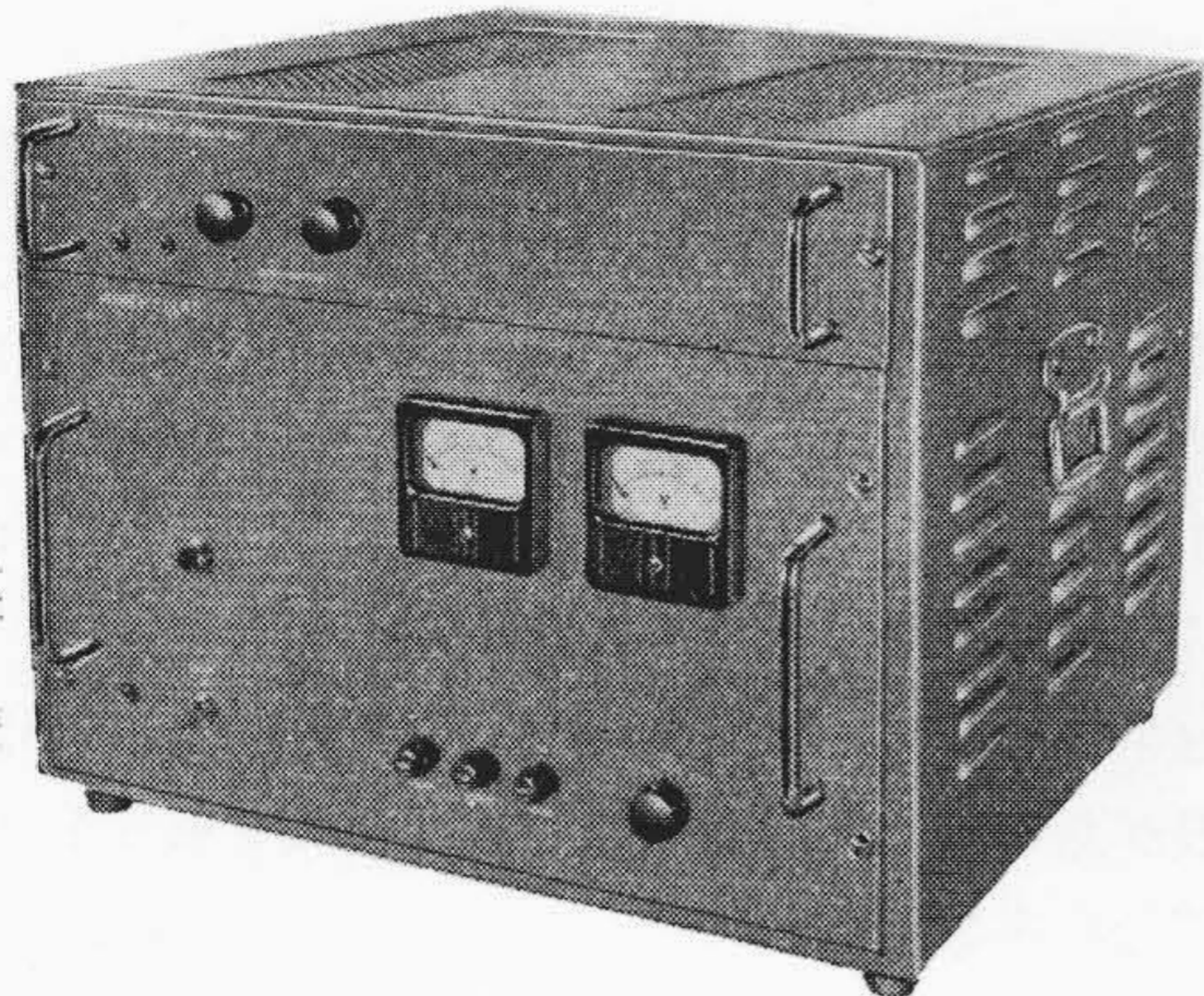
第5図 電源部 外観写真
