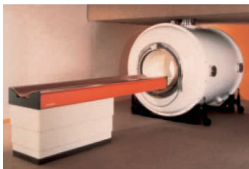
図3 1983 年東京大学へも導入された最初の超伝導 MRI 製品 (0.35T)
