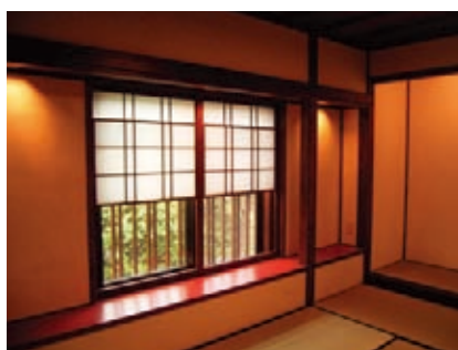
紙障子で日射を遮るとともに視線を制御する
