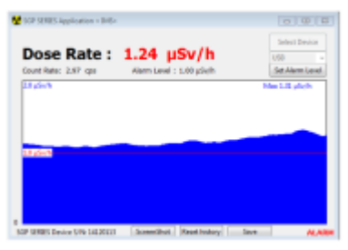
図 2. PC のソフトは、線量率の直接的なビジュアル化、取得データの管理及び管内部パラメータの設定が可能
