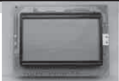
写真2 グラフィック表示が可能な液晶モジュール 秋月で入手可能な128×64ドットのフルグラフィック液晶モジュール。図形などの自由な表示が可能だが、文字を表示する際には、フォントを準備する必要がある。受信機のフロントパネルとして使いこなすのはかなり難易度が高い
