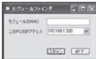
図2 LAN内のSDR-49を発見するためのモジュールファインダの画面 モジュールファインダの実行にはあらかじめ.NET Frameworkをインストールしておく必要がある
