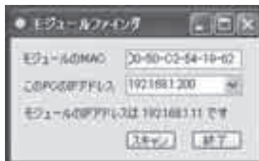
図3 モジュールファインダでSDR-49を発見したときの画面 SDR-49のMACアドレスの先頭の特徴を検出して数あるLAN機器の中からSDR-49を見つけ出すことができる
