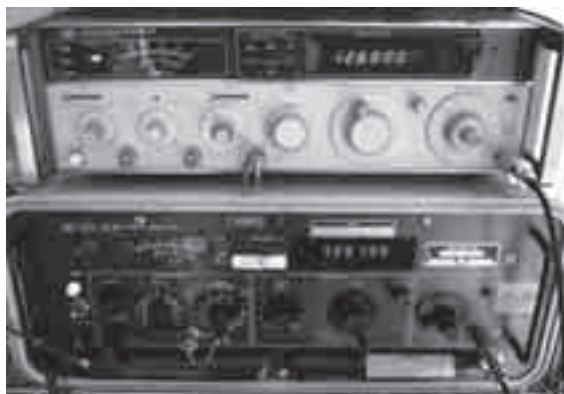
写真5 今回使用したシグナル・ジェネレータ 筆者が愛用しているシグナル・ジェネレータ。上段が民生品のHP-8640Bで下段がミリタリ仕様のHP-8640B OPT323。2信号特性や混変調の評価のために、シグナル・ジェネレータは2台1組で使用するのが基本。今回は民生品が局発用で、感度測定にミリタリ仕様を使用した
