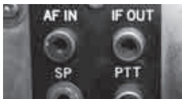
写真4 FT-101E背面にあるIF OUT端子フィルタに入る前の3180kHzの中間周波数が出力されている。またこの端子に3180kHzの信号を入ると送信させることも可能。このほかにも数々の信号端子が実装されている
