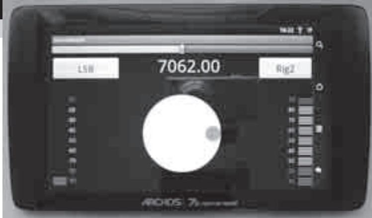
写真3 7インチの画面を持つAndroidタブレット。電話の機能はないがWi-Fi接続でインターネットに接続するとパソコンと同様に使えるツールになる。この画面はSDR-49をコントロールするためのAndroidRadio(開発中)を実行しているところ。画面上部のスライドバーを指でスライドさせると大きく周波数を変えられるし、中央のダイヤル部分で指をクルクル滑らせるとファイン・チューニングが行える。左側がSメータ表示で右側がAFレベルの表示になっている
