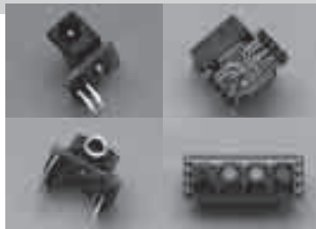
写真8 ブレッド・ボード用の便利パーツ ブレッド・ボードを利用した製作を行う際には、このようなブレッド・ボードに挿入可能なパーツをあらかじめ製作しておく極めて便利だ。左上はACアダプタ・ジャック、右上はRJ-45コネクタ、左下はφ3.5のオーディオ・ジャック、右下は操作スイッチをブレッド・ボードに挿すためのアダプタ。筆者はプリント基板を製作してもらう際に、基板の隙間で製作した。通常は蛇の目基板をカットして自作するといだろう
