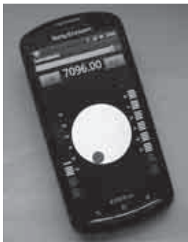
写真4 スマートフォンの例。無線回線を通じて常にインターネットに接続しているため場所を選ばずSDR-49にアクセスして無線機をコントロールできる。この画面はAndroidRadioを実行中だが、縦長の画面にあわせて自動的に画面レイアウトが変更されている
