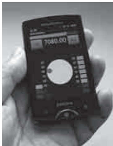
写真5 超小型スマートフォンの例。手のひらにすっぽり収まる小型のスマートフォン。画面サイズに合わせて自動的に操作パネルのレイアウトが変更されていることがわかる。BlueToothヘッドセットを利用することもできる
