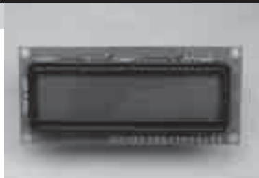
写真1 16文字×2行の液晶モジュール 秋月などで入手可能な代表的な液晶モジュール。特にこの16文字×2行のSC1602シリーズは、バリエーションも豊富で安価で使いやすい。PICマイコンと組み合わせのキットも用意されているのですぐにプログラム作成を開始できる。文字を表示するなら、お勧めのモジュールだ
