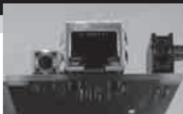
写真2 LAN経由でSDR-49を制御するためのRJ-45コネクタ。まず家庭内にあるWi-FiルータにSDR-49をLANケーブルで接続する。これでSDR-49はLANに接続される。同様にAndroidタブレットをWi-Fiで接続するとLANを通じてAndroidタブレットとSDR-49が通信可能になる
