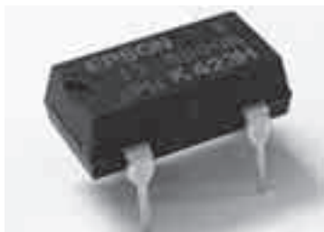
写真9 発振モジュール エプソントヨコムSG-8002DC CMOSレベルの方形波を出力する便利な発振モジュール。秋月電子通商では300円で入手可能。さまざまな周波数の製品があるが、今回は偶然にも12.8MHz品が八重洲無線の旧世代の中間周波数にベストマッチだった
