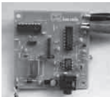
写真7 ハイブリッド改造を施した本誌2006年12月号の付録ソフトウェア・ラジオ基板 本文で解説した改造を施した基板。右側のアンテナ端子にはFT-101EのIF OUTからの信号を、左側のコンデンサにはシグナル・ジェネレータからの局発を接続する。周波数変換されたI/Q信号は下方のφ3.5のオーディオ・ジャックからSDR-49に接続する
