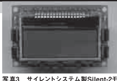
写真3 サイレントシステム製Silent-2モジュール 128×32ドットのグラフィック液晶とマイコンを組み合わせたモジュール。文字色は黒でバックライトが白なのでコントラストが高く液晶表示がとても見やすい。DSP-49発売時に今回のファームウェアを書き込んで提供されるとのことで、プログラムが不要になるのがうれしい
