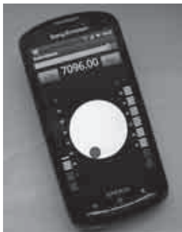
写真1 代表的なスマートフォンの例 無線回線を通じて常にインターネットに接続しているので場所を選ばずリモート運用ができる。AndroidRadioアプリを起動したところ
