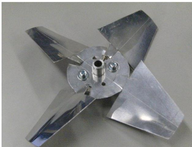
ファンの取り付け部品はファン同様に軽量化を図るためアルミで作製した。ファンへの取り付けは 4 か所をボルト・ナットで固定し、軸への取り付けは軸の半径方向にボルトで締め付けることで固定する。図 2.4.2 に実際にファンに取り付けた図を示す。ファンへの取り付けとして 4 か所固定する部分を設けていたが、4 か所をボルト・ナットで固定すると重量が思っていたより増えたため 2 か所で固定することにした。また、圧縮機側では耐熱が必要ないことから固定するボルト・ナットをプラスチック製のものを使用し軽量化を図った。
