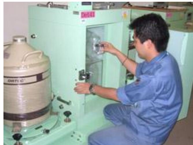
ゲルマニウム半導体検出器 (写真:(財)日本分析センターホームページより) 9
