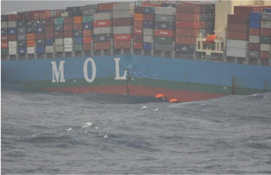
図 1.3.1 事故時の事故船の状態（亀裂の進展方向（商船三井提供））
