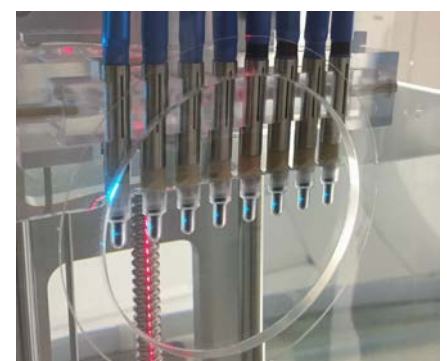
図 12 水深 2.9 mm から測定可能な新型薄窓水ファントム装置
