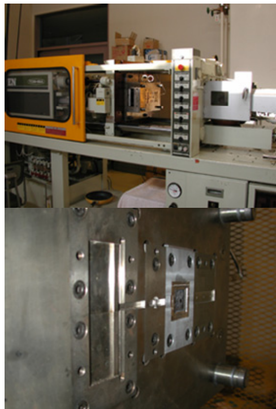
図9 プリズムシート転写電鍍金型の成形実験 (上: 射出成形機 下: モールドベースに組込んだ電鍍金型)
