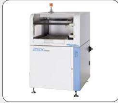
走査型蛍光X線分析装置 ZSX Primus (下面照射)
