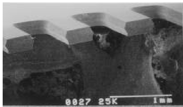
図 21 エッチング式形成方法
