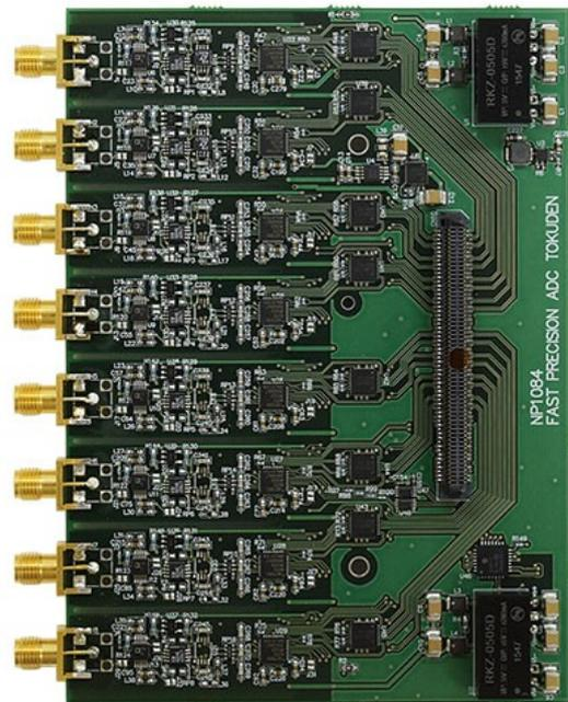
写真 2 18bit 拡張 ADC ボード
