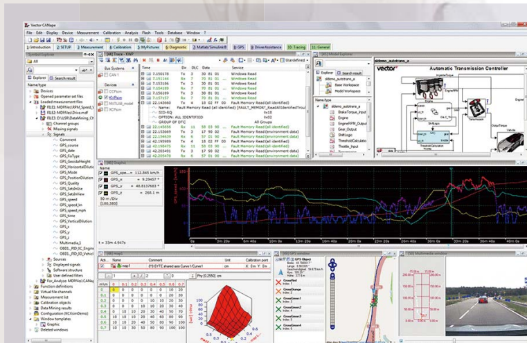
図3. ECU の測定/ キャリブレーションツール「CANape」
