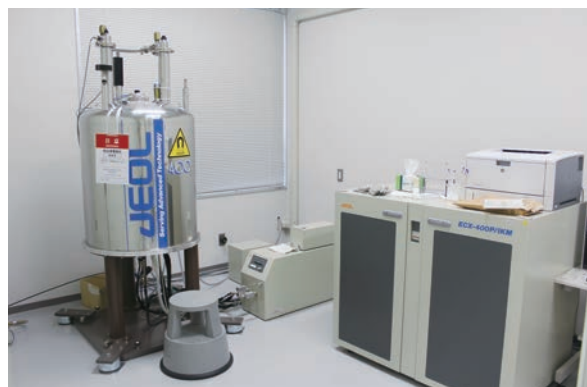
図3 石川県立大学の400 MHz NMR装置 (日本電子ECX-400P型)
