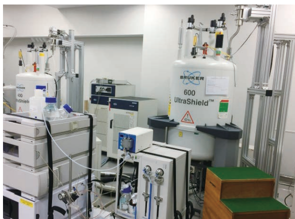
図1 LC(-SPE)-NMRシステム (Bruker社製 600 MHz NMR装置)
