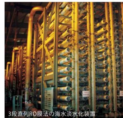
3段直列RO膜法の海水淡水化装置
